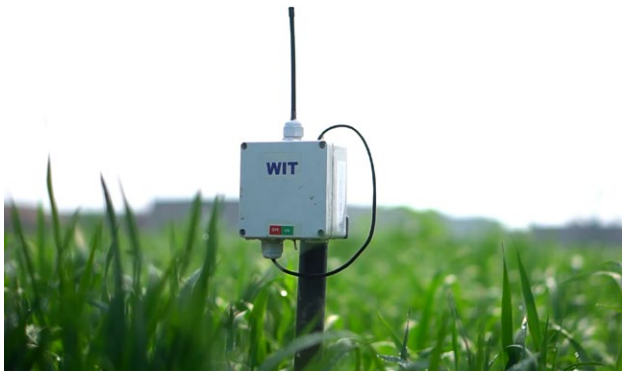
Fotografía Sensor de humedad del suelo aplicado en maíz y alfalfa – Pakistán
