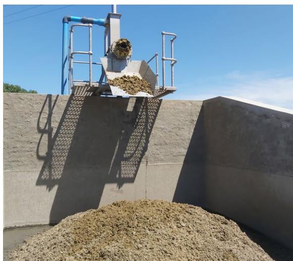
Fotografía: Prensa de estiércol en una granja proveedora de Nestlé - Sudáfrica
